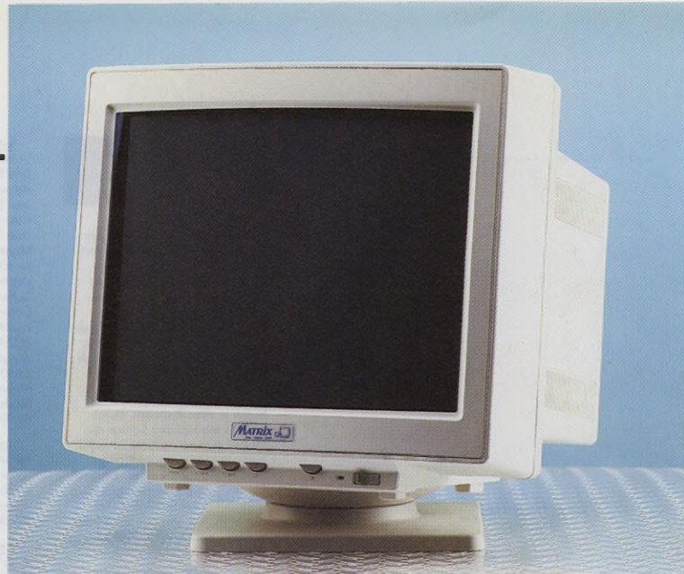
Bild 2. Die C110 ZV ist mit einer VME-Schnittstelle und 2 MByte Videospeicher ausgerüstet
