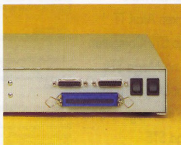
SCSI Schnittstelle an Geräterückseite herausgeführt
